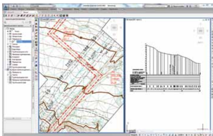
Рис. 2. Трасса автомобильной дороги, укрупненный продольный профиль
