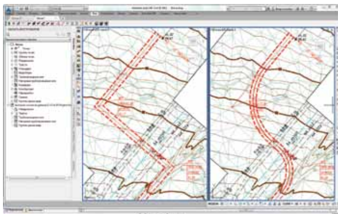
Рис. 3. Исходная и проектная модели трассы автомобильной дороги
